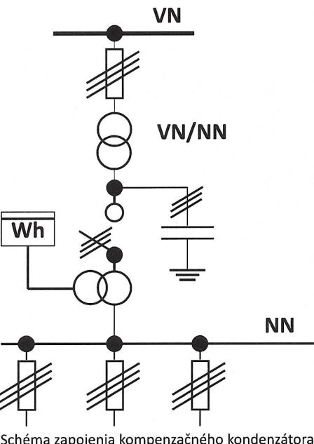
Schéma zapojenia kompenzačného kondenzátora
