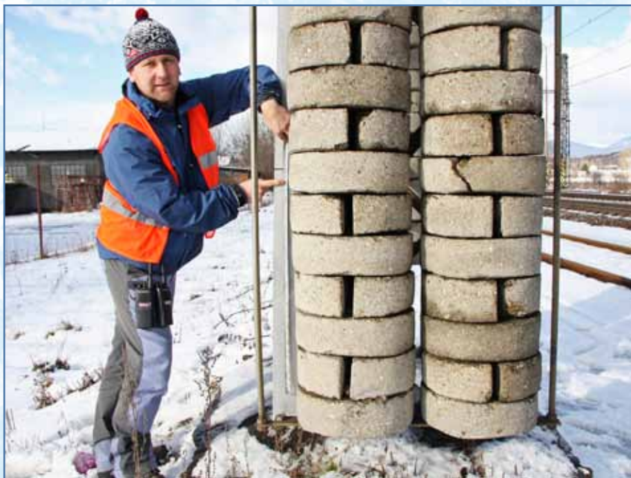
Ing. Roman Frič meria na kotviacej podpere zmenu polohy napínacieho systému trolejového drôtu a nosného lana. Záväžia počas skúšky poklesli až o 80 cm.
