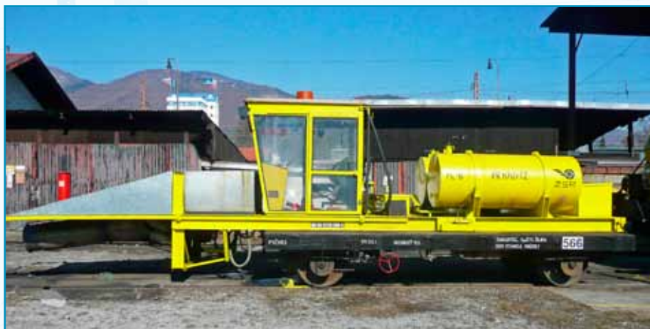
Prúdový rozmrazovač PR M 701 sa skladá z leteckého turbokompresorového prúdového motora M-701, ovládacej kabínky a dvoch palivových nádrží s celkovým objemom 2500 litrov leteckého petroleja.
