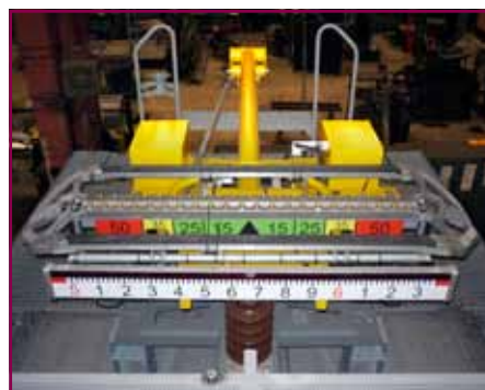
Nový merací pantograf na streche vozňa, vybavený diagnostickým zariadením a optosnímačmi, je určený na meranie, registráciu a vyhodnocovanie geometrickej polohy trojkoľového drôtu trakčného vedenia.
