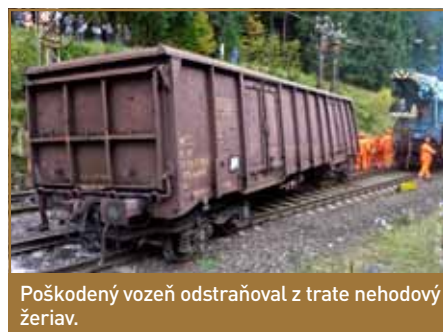
Rozbité podvaly, popraskané koľajnice, poškodené zabezpečovacie zariadenie a zdeformované výhybky. Takáto spúšť zostávala za vykoľajeným vozňom so železnou rudou.
