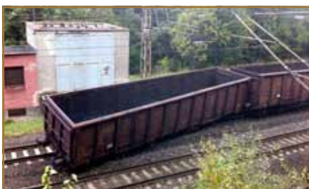
Vykoľajený vozeň zasahoval do priechodného profilu susednej koľaje, doprava musela byť zastavená.
