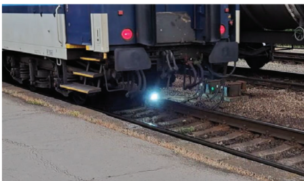
Horenie izolovaného styku
