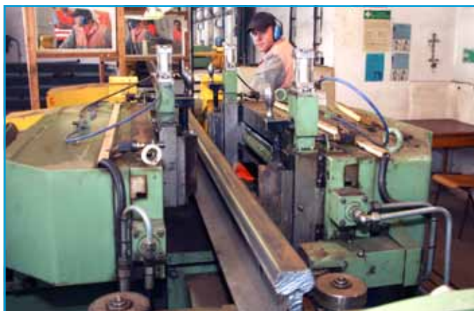
Marián Roľko hydraulickou rovnáčkou vyrovnáva použitú koľajnicu v horizontálnej aj vertikálnej rovine.
