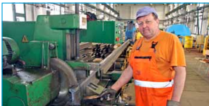
Vladimír Hríb hydraulickou kotúčovou píťou vyrezáva skryté chyby v koľajnici zistené defektoskopickou kontrolou.
