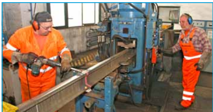
Dušan Gallo (vľavo) za tepla orezáva čerstvý zvarový styk, ktorý pred chvíľou vyšiel zo zvaracieho stroja K-1000. Toto zariadenie riadené počítačom obsluhuje Jozef Galis.
